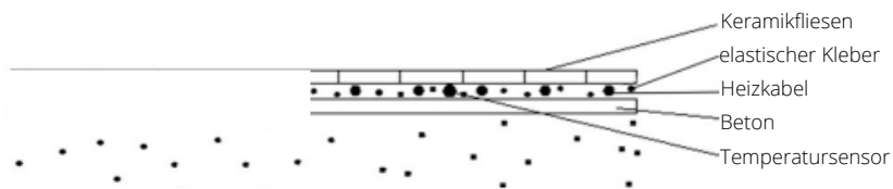
Abbildung 2: Direkt auf dem Beton
