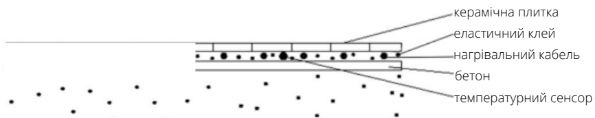
Малюнок 2: Безпосередньо на бетоні
